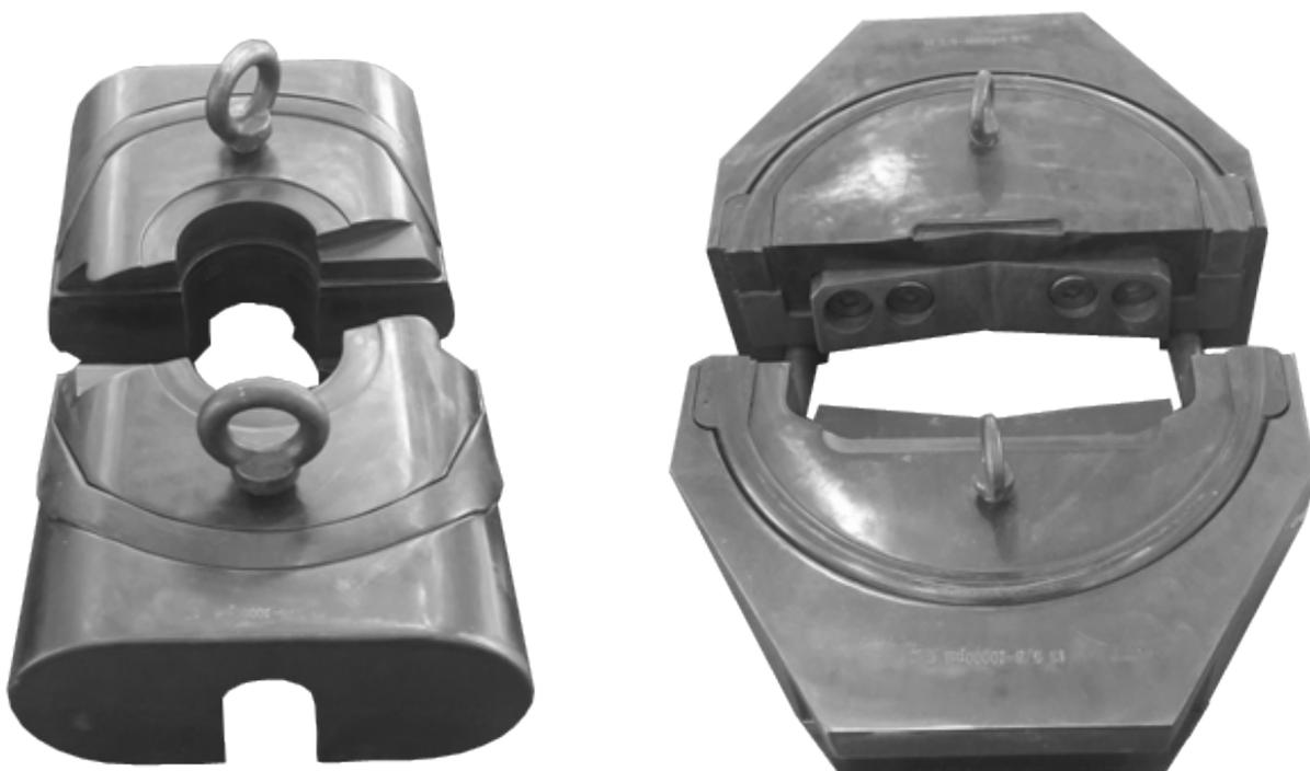
Плашки трубные с постоянным и переменным диаметром предназначены для работы в составе плашечного превентора для герметизации кольцевого зазора между спущенной в скважину обсадной колонной и бурильными трубами.
